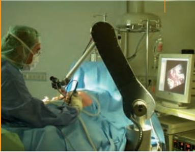
Der SOLOASSIST der Firma Micro-Epsilon, Ortenburg, ist ein Kamera-Manipulatorarm, der den Chirurgen bei minimal-invasiven Bauchoperationen (Schlüsselloch-Chirurgie) entlastet und die Operationsqualität deutlich erhöht.
